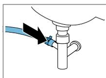
Зафиксируйте соединение хомутом (24-40 мм).
