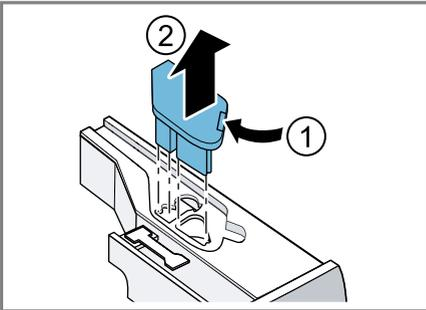
5. Расфиксируйте крышку кюветы для моющих средств и снимите ее.
