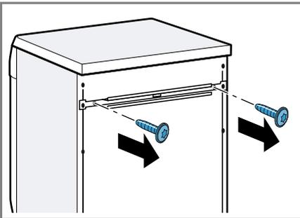
4. Снимите транспортировочную распорку.
