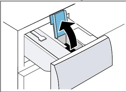
3. Заполните жидким моющим средством ◊ и кондиционером ⊗ соответствующие дозаторы.
