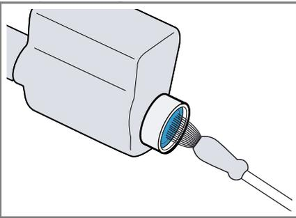
3. Подсоедините шланг для подачи воды и проверьте герметичность соединения.
