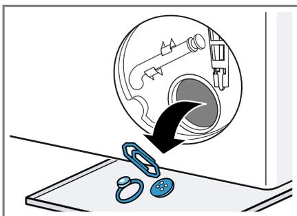
Крышка насоса состоит из двух деталей, которые можно разобрать при очистке.
