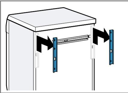
3. Отверните и снимите винты горизонтальной транспортировочной распорки отверткой T20.
