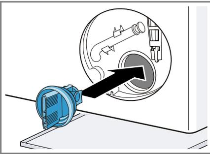
5. Вставьте и закрутите до упора крышку насоса.
