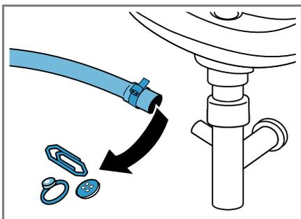
5. Подсоедините сливной шланг и зафиксируйте место соединения хомутом.
