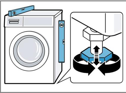
Все ножки прибора должны прочно стоять на полу.
