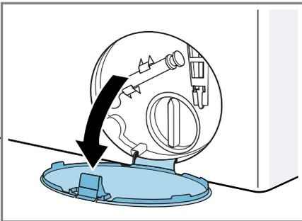
5. Снимите дверцу для технического обслуживания.
