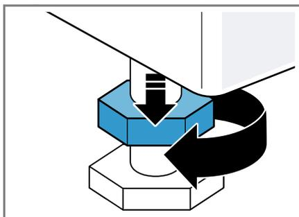
2. Выравнивание прибора осуществляется путем вворачивания и выворачивания регулируемых ножек. Проверьте выравнивание по уровню.
