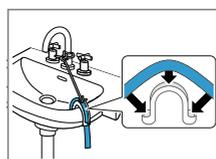
Зафиксируйте и закрепите скобой сливной шланг.
