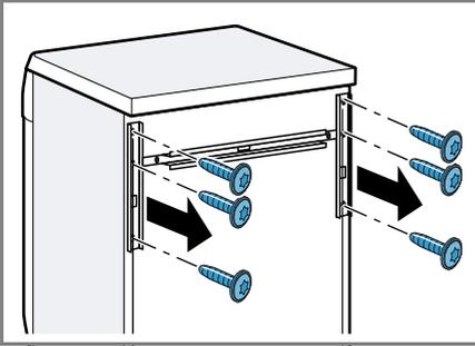
2. Снимите транспортировочные распорки.
