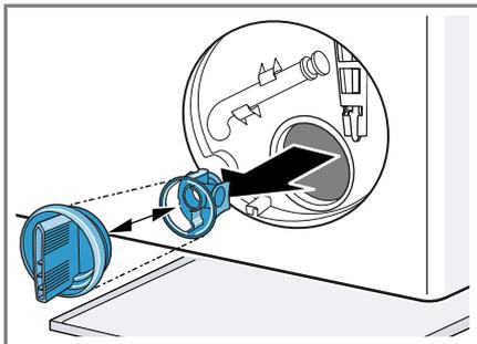
2. Очистите внутреннюю поверхность, резьбу крышки насоса и корпус насоса.
